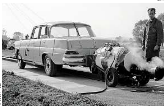
Při crashtestech používal Mercedes parní raketu, která vůz dotlačila až k bariéře. Raketa se občas vymkla kontrole a skončila i s autem ve vodním příkopě, který obklopoval zkušební areál.
