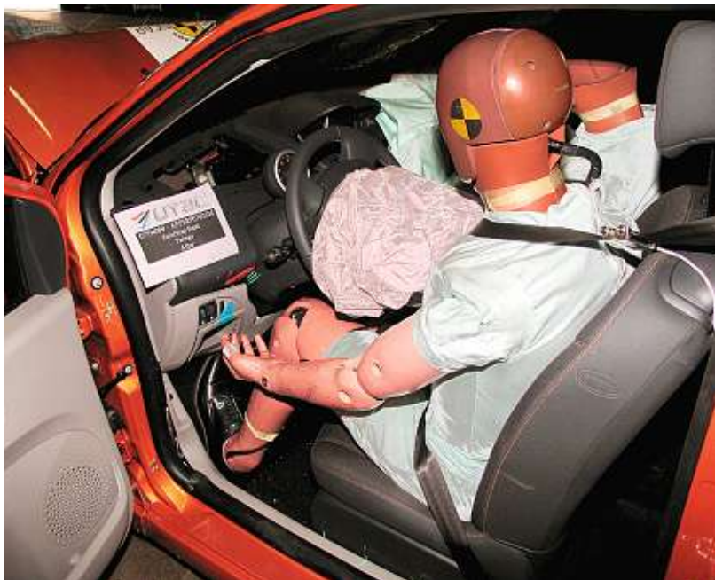
Tvrdá přístrojová deska v Renaultu Twingu představuje nebezpečí pro kolena a stehna cestujících na předních sedadlech.
