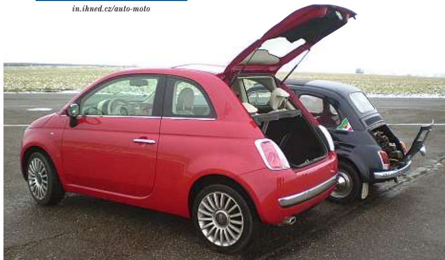
Tam, kde má stará pětistovka motor, je u novinky kufr. Na jeho slušném objemu 185 litrů má největší zásluhu chybějící rezervní kolo – místo zbylo jen na lepicí sadu s kompresorem.
