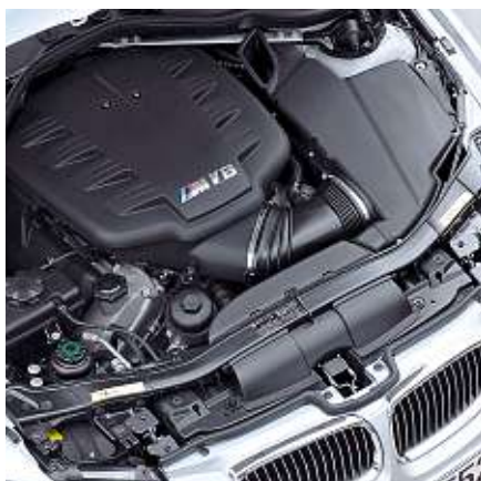
Osmiválec BMW váží 202 kg, o patnáct méně než šestiválec předchozí generace M3.
