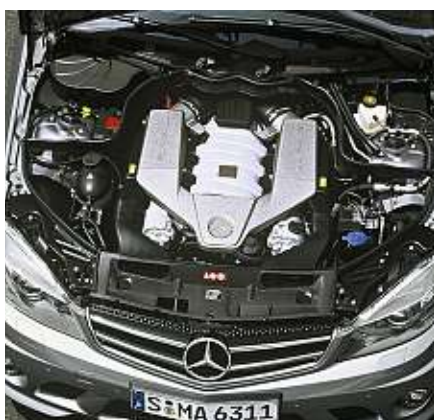
Pod kapotou mercedesu je osmiválec s neuvěřitelným objemem 6,2 litru.
