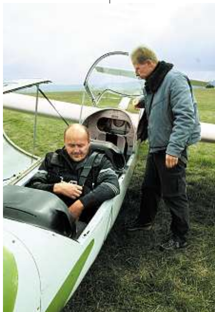
Celokovový dvoumístný kluzák L-23 Superblaník je jedním z nejoblíbenějších bezmotorových letadel na českých letištích.
