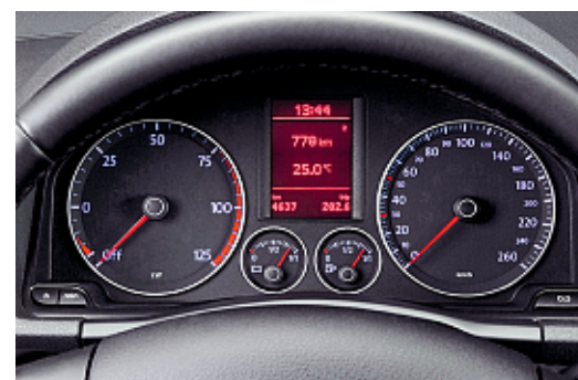
Přístrojová deska Volkswagenu Golf TwinDrive kombinuje údaje elektrického i konvenčního pohonu.
