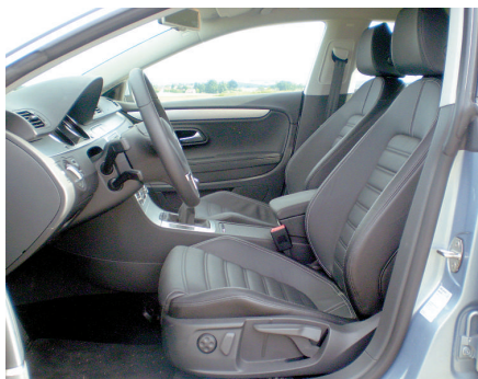
Sériová anatomická sedadla mají dobré boční vedení těla a nastavitelnou podporu bederní páteře.
