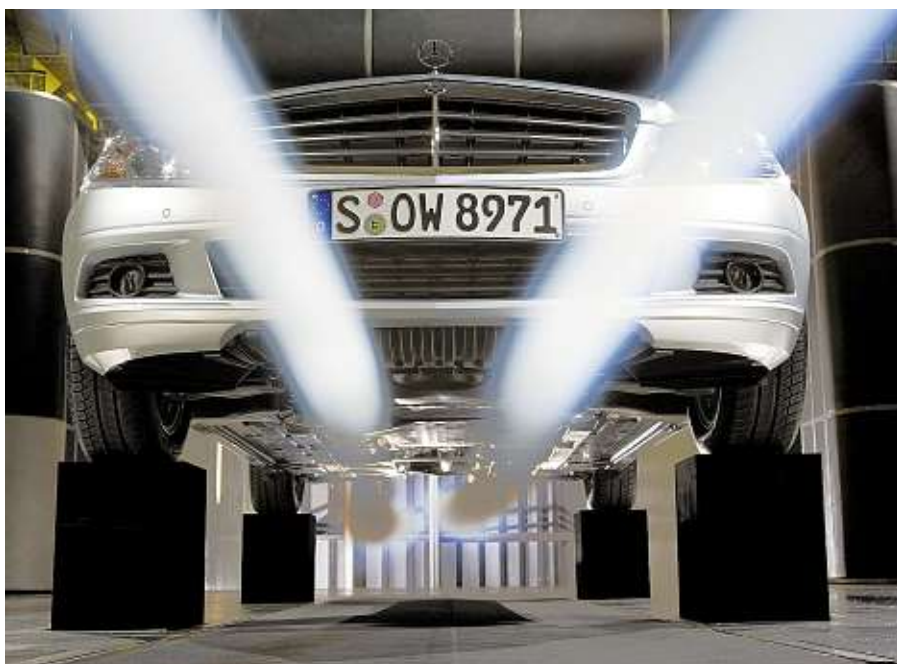
Pečlivě zakrytí podvozku snižuje odpor vzduchu, a tím i spotřebu. U úsporných modelů je takové opatření samozřejmostí.
