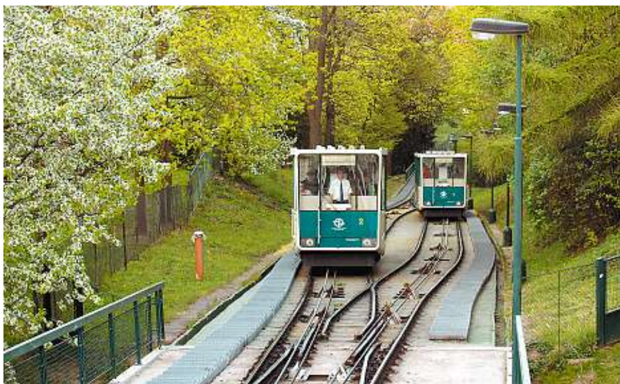
Vozy petřínské lanovky mají kapacitu 100 osob a elektrický pohon. Rychlost jízdy je 4 m/s, lanovka se ovládá z horní stanice.
