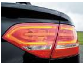
Exkluzivitu dodává vozu použití optických kabelů v zadních sdružených svítilnách.
