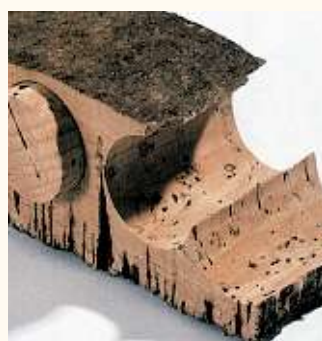
Zátka vyražená z kusu korku pomocí ruční raznice.
