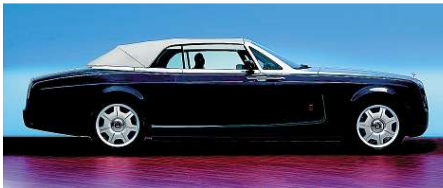
Nejdražším sériovým kabrioletem je Rolls-Royce Drophead Coupé. Dvanáctiválec 6,75 s výkonem 460 koní dokáže vůz s pohotovostní hmotností 2620 kg rozjet na rychlost 240 km/h.
