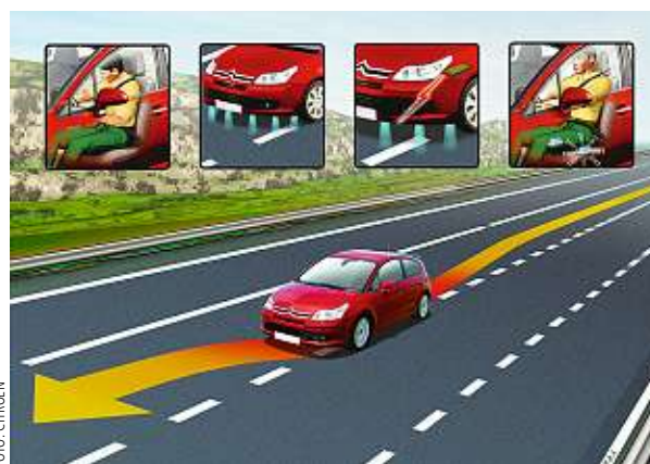
Čárový asistent má řidiče ochránit před mikrosnáním. Při nechtěném přejetí krajnice nebo středové dělicí čáry začne u Citroënu vibrovat sedadlo.
