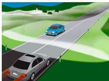
Nová generace adaptivních světel se přizpůsobí i počasí. První obrázek ukazuje auto s klasickými světly do mlhy, druhý s „inteligentním světelným systémem“ od Mercedesu, kdy elektronika upraví proud světla tak, aby zlepšila orientaci řidiče za snížené viditelnosti.
