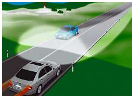
Čárový asistent má řidiče ochránit před mikrosnáním. Při nechtěném přejetí krajnice nebo středové dělicí čáry začne u Citroënu vibrovat sedadlo.
