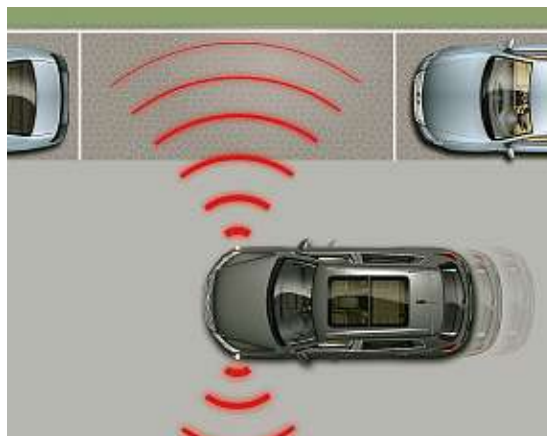
Automatický parkovací asistent změří volnou mezeru mezi stojícími auty, a je-li dostatečná, sám do ní zacouvá.
