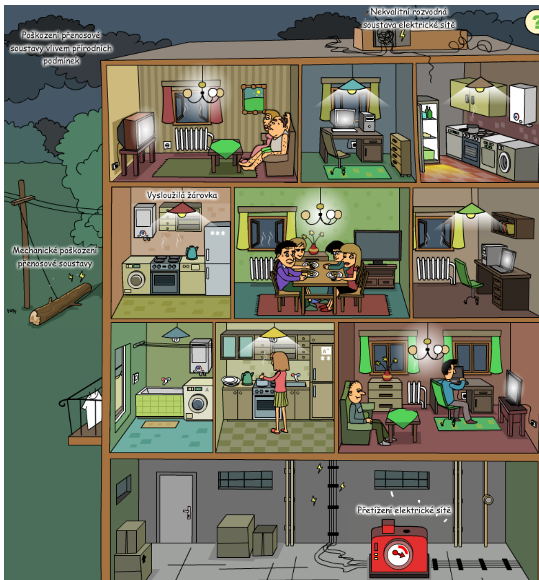
Obrázek 3: Příčiny blikající žárovky
