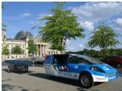
Energii získanou z fotovoltaických panelů si Solar-taxi veze s sebou.
