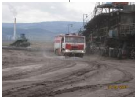
Zahájení protiprašných opatření v prostoru Severního lomu.
