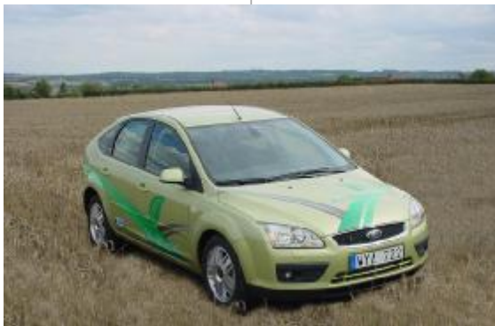
Ford Focus Flexifuel upravený na pohon jak benzínem, tak palivem E 85 či jejich kombinací má průměrnou spotřebu benzínu 8,5 l/100 km, zatímco spotřeba paliva E 85 činí 10,85 l/100 km.
