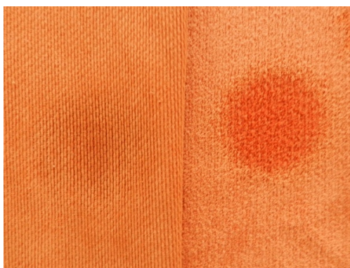
Stejné množství vody nalité na rub a na líc tkaniny Prowell – lícni bavlněná froté strana (vpravo) vodu vsákla, rubová polyesterová (vlevo) ji přenesla a zůstala suchá.
