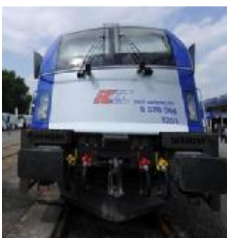
Lokomotiva je vybavena motorem o objemu 11 tisíc kubiků s trvalým výkonem 180 kilowatt.
