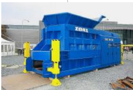
Vítězný exponát: hydraulické nůžky jsou novinkou v portfoliu společnosti ŽDAS.
