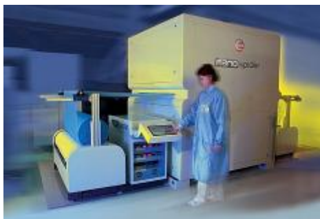
Nanospider firmy Elmarco vyvinutý ve spolupráci s TUL: první pro průmyslovou výrobu nanotextilií
