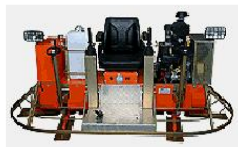
Dvourotorová hladíčka betonu s hydraulickým ovládáním. Foto: Lestte
