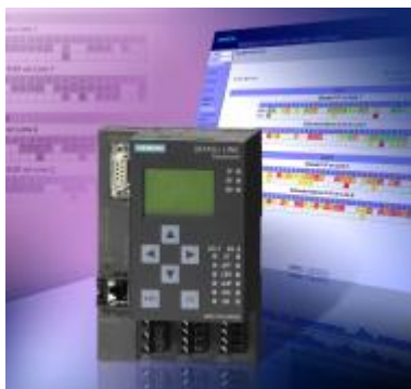
Modul DP/AS-i Link Advanced umí propojit síť Profibus a AS-Interface.
