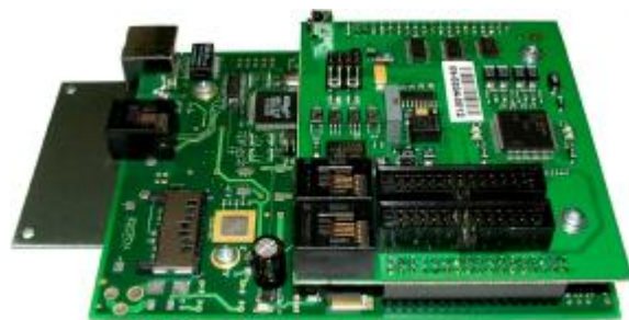
Modul změni ústřednu 2N Ateus Omega ve VoIP systém.
