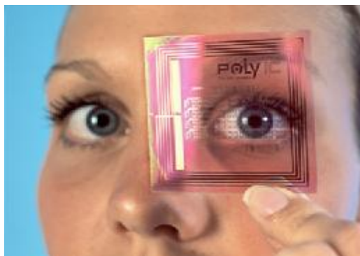
Integrovaný obvod RFID čipu je natištěn na podložce z organického plastu.
