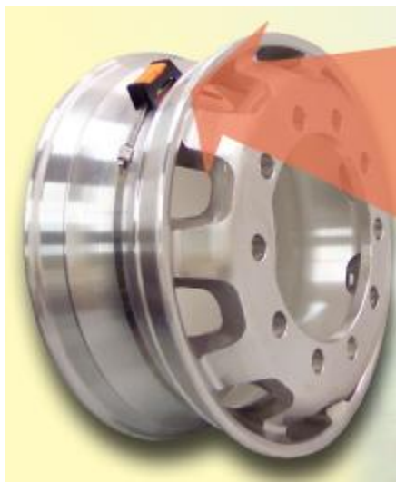
Senzory na měření tlaku jsou umístěny uvnitř pneumatik. Foto: DuPont
