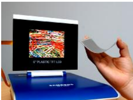
Největší TFT plastový LCD displej přináší nové možnosti také v zobrazovacích systémech průmyslových zařízení.
