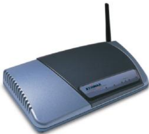
Pomocí bezdrátových print serverů lze připojovat počítače v síti k tiskárnám bez kabelů.
