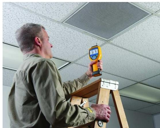
S měřicím počtem částic Fluke 985 máte k dispozici tyto funkce: měření účinnosti filtrů, sledování průmyslových čistých provozů, předběžná měření kvality vzduchu v interiérech a bezproblémová práce se specialisty v oblasti IAQ, vyhledávání zdrojů částic a jejich odstranění, potvrzování provedených oprav zákazníkům a kontrolní měření pravidelné údržby.
