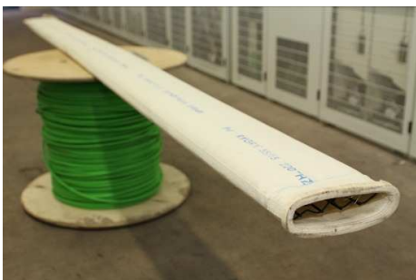
Detail tkaninového filtru, který slouží k zachycování pevných částic. Jeho životnost je zhruba pět let a jeho pravidelné čištění je zcela automatizováno.
