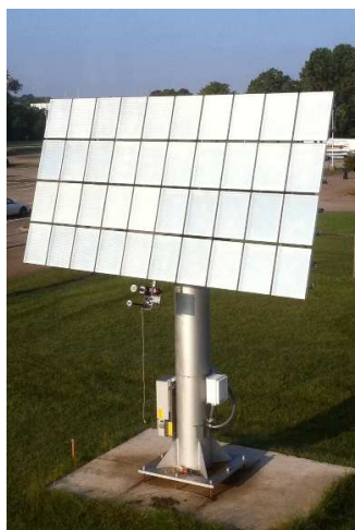
Prototyp článku se 40 koncentrátorovými moduly. Každý z nich dokáže přeměnit na elektřinu více než jednu třetinu energie z dopadajícího slunečního záření.
