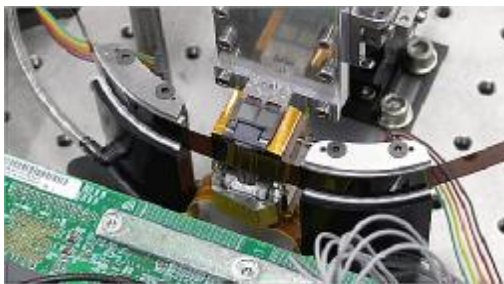
Prototyp pokročilé pásky firem IBM a FUJIFILM pojme téměř 30 mld. bitů dat na plochu 1 čtverečního palce.
