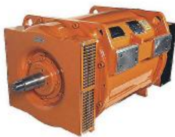
Trakční motor pro trolejbusy vyráběný ve společnosti Škoda Electric
