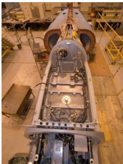
Příprava trupu dvoumístného cvičného letounu L-159T. Foto: Aero Vodochody
