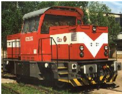
Nová lokomotiva řady 709.4 s motorem Caterpillar C15 o výkonu 369 kW pro Srbské dráhy.
