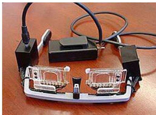
Prototyp „digitálních brýlí“, které pomocí elektroniky řeší problém potřeby různých optických parametrů.
