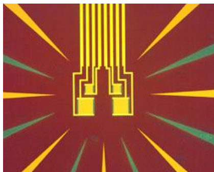
Čtyři žluté čtverečky jsou mikroskopické záběry detektorů jednotlivých fotonů.
